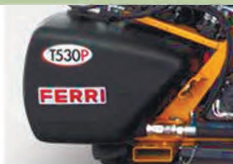
ГИДРОБАК ИЗ ПОЛИМЕРОВ LLDPE ДЛЯ ОБЛЕГЧЕНИЯ КОНСТРУКЦИИ
