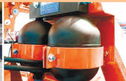
ОХЛАЖДЕНИЕ ГИДРАВЛИКИ, АЗОТНЫЙ АККУМУЛЯТОР
