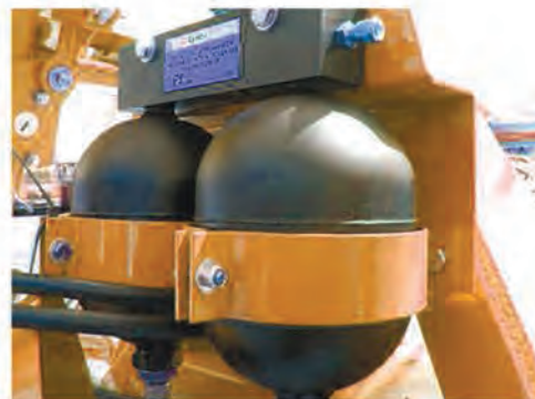
ОХЛАЖДЕНИЕ ГИДРАВЛИКИ, АЗОТНЫЙ АККУМУЛЯТОР
