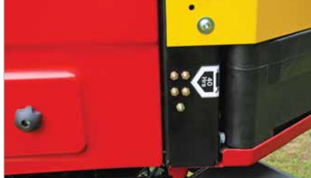
Центральный пост смазки
