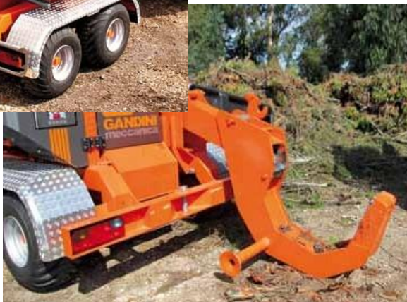
Автоматический радиоуправляемый раскальватель бревен с гидравлическим приводом
