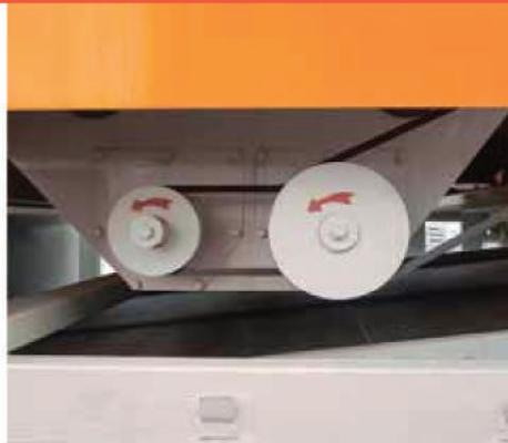
Двойная система аспирации - эффективная двухпоточная очистка (выделение соломистых примесей на входе и сортировка по аэродинамическим свойствам на выходе)
