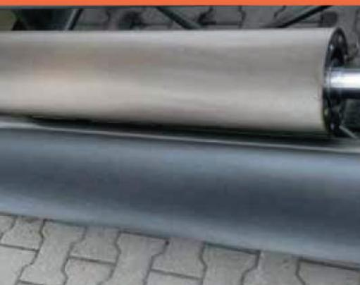
Вальцы с титановым или азотированным покрытием с ресурсом до 48 000 тонн
