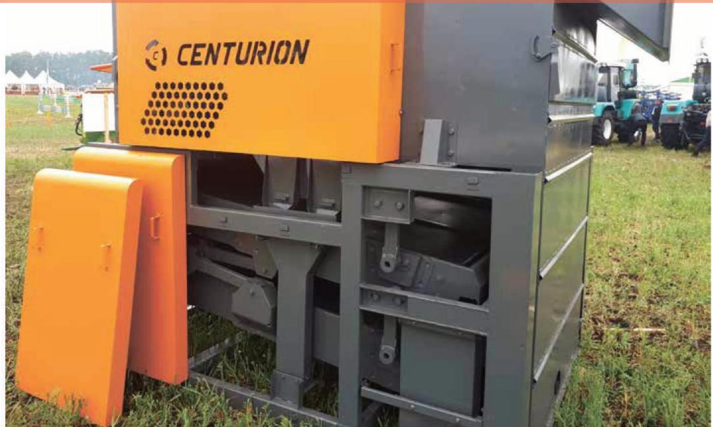
Универсальный стационарный сепаратор Centurion SU 60 предназначен для предварительной, первичной и вторичной очистки зерна и семян зерновых, колосовых, крупяных, зернобобовых, масленичных культур, семян трав от легких, крупных и мелких примесей, отделяемых воздушным потоком и решетами.
