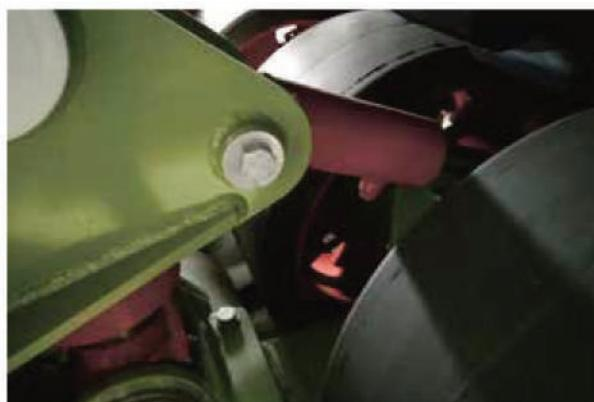
Гидравлический натяжитель HARD-TRAIL обеспечивает автоматическое натяжение гусеничной ленты
