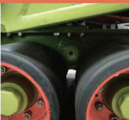
Тандемное крепление роликов – равномерная нагрузка на грунт
