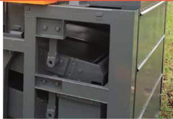
Улучшенные виброопоры, оснащенные специальными резиновыми втулками, которые гасят колебания
