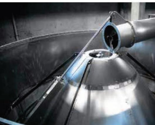
Центральный шnek с наплавкой из стали Hardox
